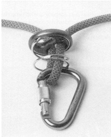
Figura 16. Mecanismo para asegurar: placa Sticht con muelle
